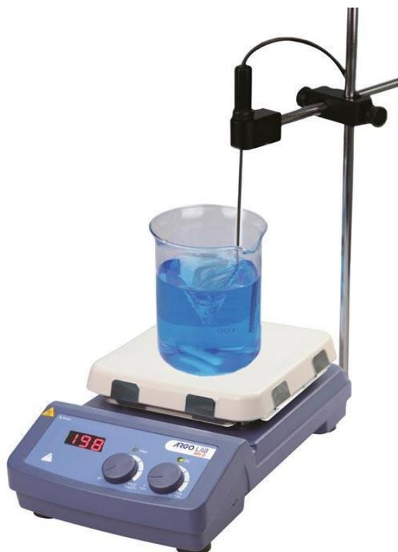
Agitador magnético **digital** con microprocesador con placa calefactora **vitrocerámica**. Pantalla LED con indicación continua de temperatura. Control y ajuste de la temperatura máxima de protección con alarma visual en el display.
