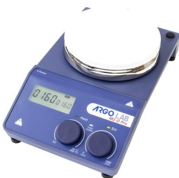
Agitador magnético **digital con microprocesador con placa calefactora.**
